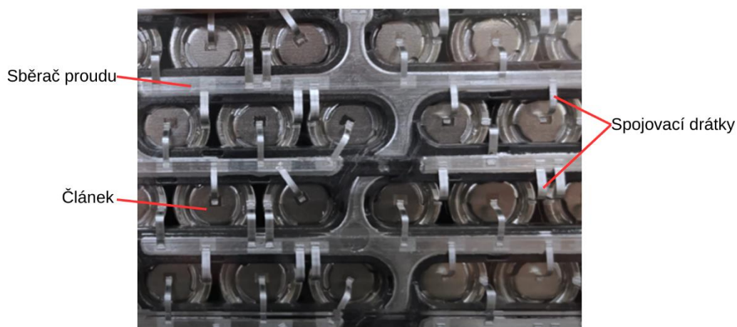
Obr. 12 Detail spojení cylindrických článků se sběračem proudu modulu pomocí jemných drátků u akumulátoru vozidla Tesla Model S, upravené [18]
