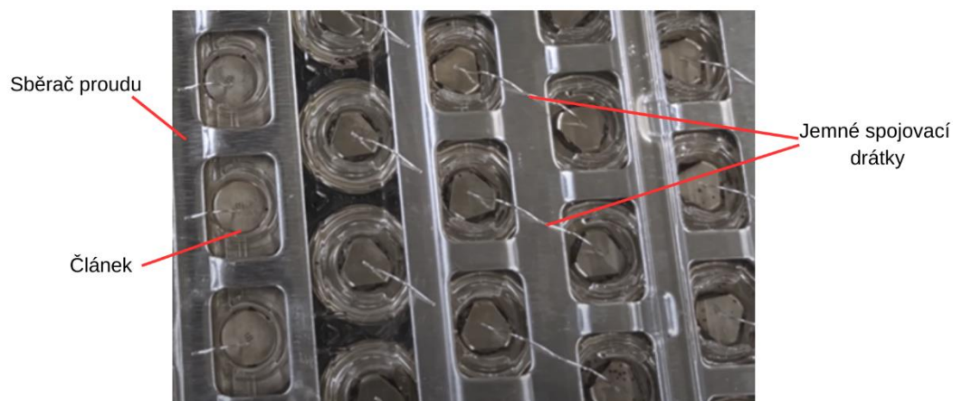
Obr. 13 Detail spojení cylindrických článků se sběračem proudu modulu pomocí jemných drátků u akumulátoru vozidla Tesla Model S, upravené [18]
