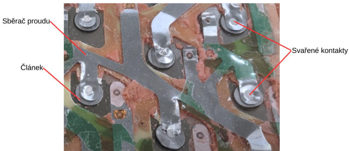
Obr. 14 Laserem svařovaný kontakt mezi článkem a sběračem proudu modulu u nejnovějších modelů Tesla Model S a X, upravené [18]
