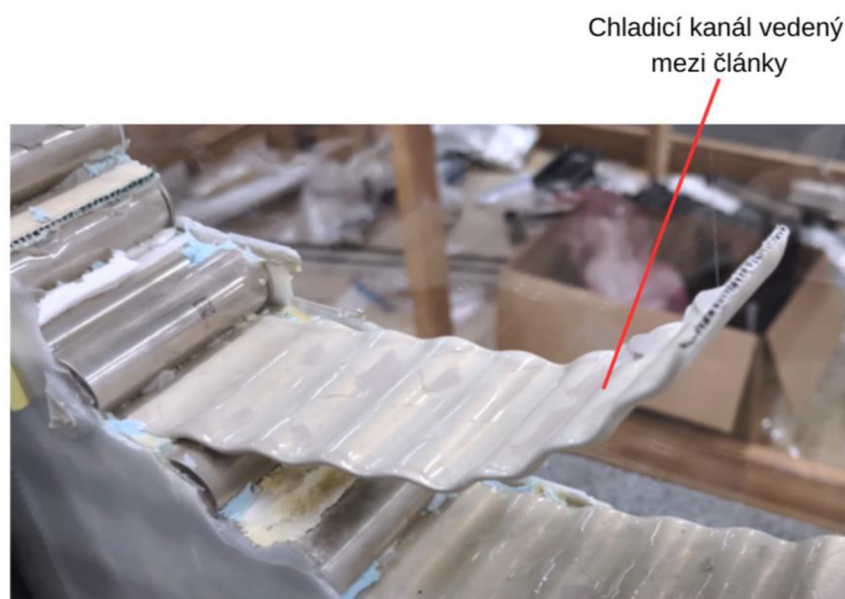
Obr. 19 Akumulátor z Tesla Model Y s chladičským kanálem vedeným mezi články, upravené [18]
