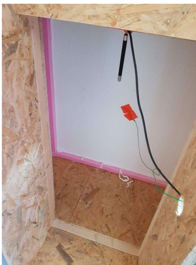
Obrázek 25: Chladná strana skříně – zkušební měření
