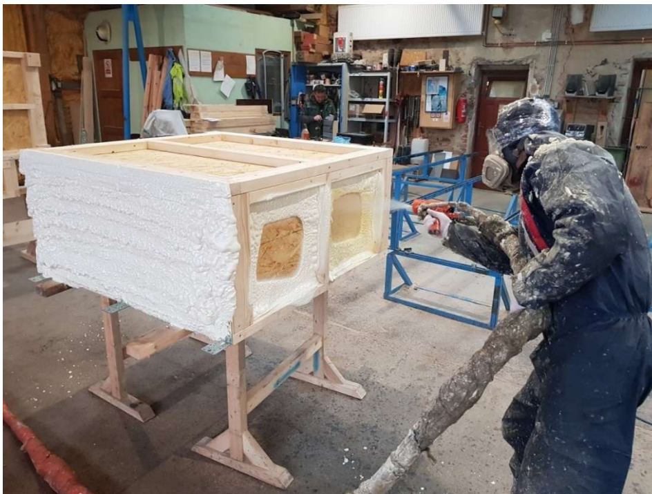
Obrázek 22: Aplikace PUR pěny na skříň
