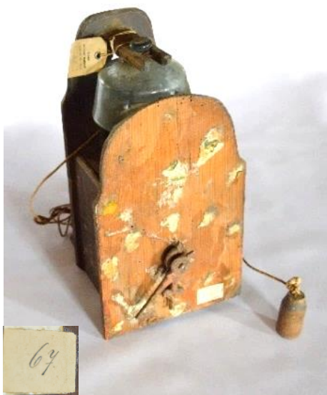
Obr. 112: selské nástěnné hodiny Schwarzwald s dřevěným strojkem (včetně ozubených koleček), nedochovaný ciferník; 28 x 19 x 16 cm. LM00927
