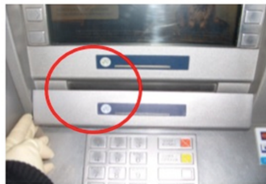
minikamera ukrytá v liště, která je přilepena přes otvor pro výdej peněz
