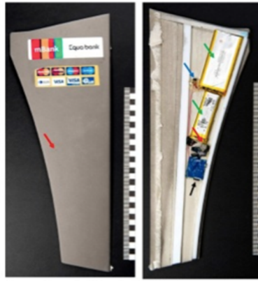
minikamera ukrytá v bočnicích těla bankomatu (po stranách obrazovky)
