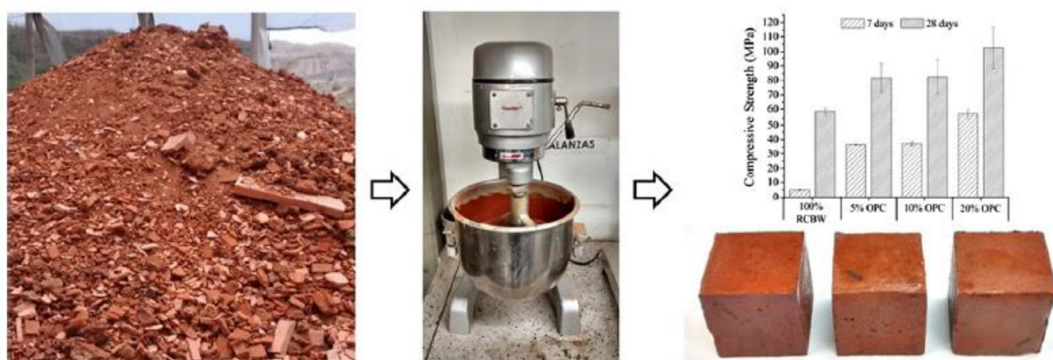
Obr. 5. Výroba alkalicky aktivované matrice z odpadních cihlářských výrobků. [31]
