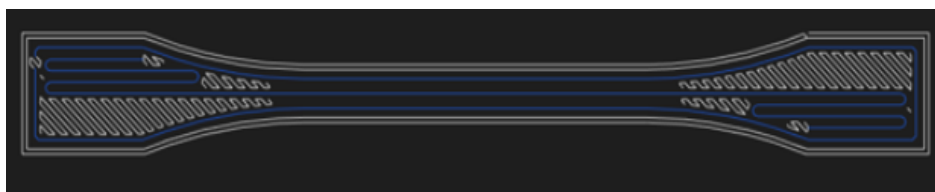
Obr. 29 Extrudovaná vrstva obsahující CF vlákno.
