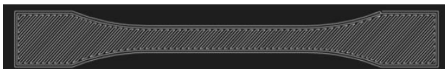
Obr. 30 Extrudovaná vrstva materiálu Onyx (výplň 100 %).
