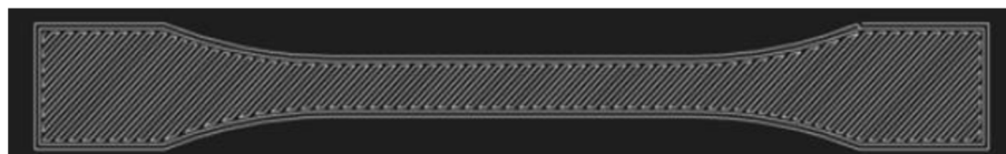
Obr. 30 Extrudovaná vrstva materiálu Onyx (výplň 100 %).
