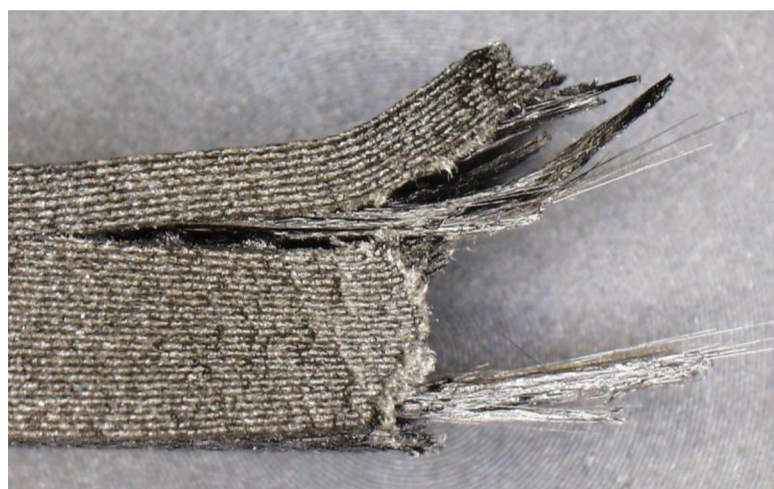
Obr. 46 Detail normovaného lomu zkušební tyče s CF vlákny (24x zvětšeno).
