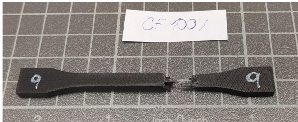
Obr. 45 Detail normovaného lomu zkušební tyče s CF vlákny.
