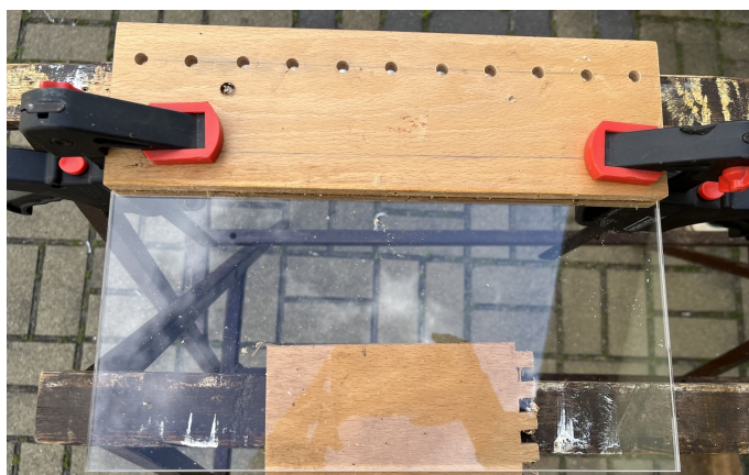
Obrázek 7.1: Vrtání mřížky pomocí šablony (zdroj: autor)
