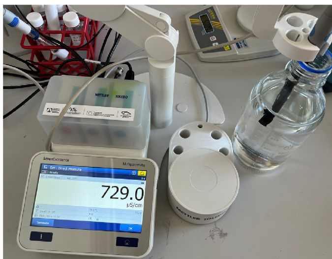
Obrázek 7.14: Měření vodivosti namíchaného roztoku pomocí konduktometru (zdroj: autor)
