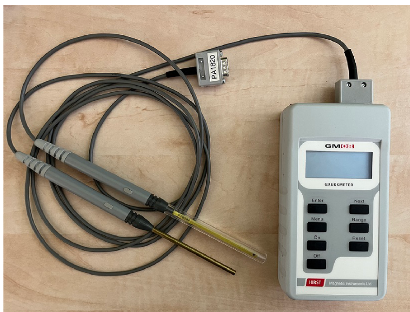
Obrázek 7.17: Teslametr pro měření magnetického pole (zdroj: autor)
