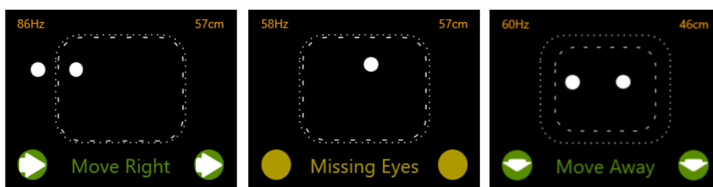
Obrázek 14: Nevyhovující polohy očí s instrukcemi pro správné usazení respondenta (Zdroj: Nálevka, 2020)
