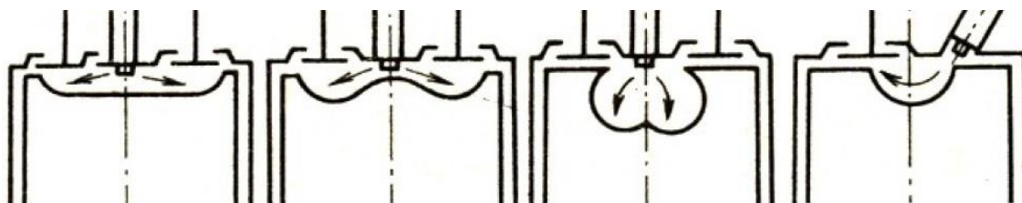
Obr. 7 Spalovací prostory v pístu (zleva: MAN, Hesselman, Saure, polokulový) Zdroj: webové stránky Příprava směsi u spalovacích motorů (2016)
