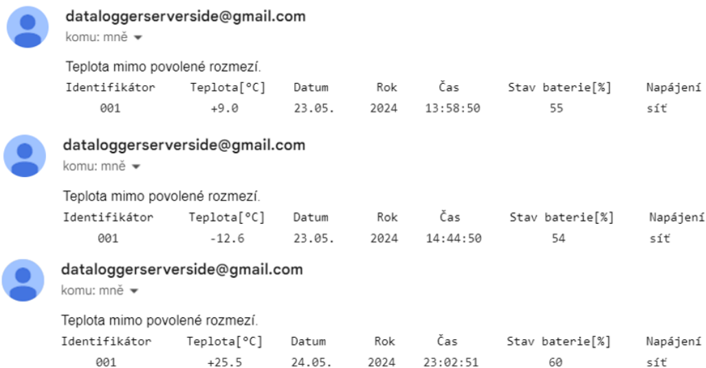
Obr. 7.8: Ukázka varovného e-mailu při různých teplotních výkyvech
