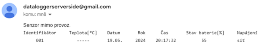
Obr. 7.9: Varovný e-mail při odpojení senzoru
