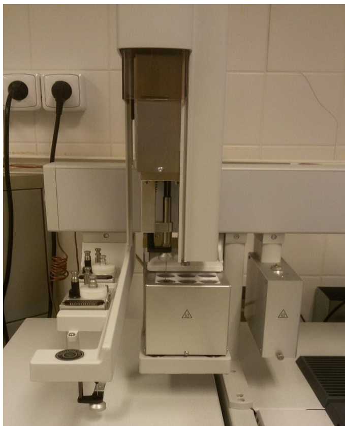
Obrázek 7: Autosampler TriPlus RSH pro přímý nástřik kapalin, headspace a SPME nástřik
