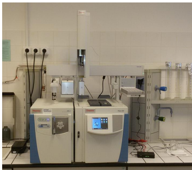
Obrázek 6: Použitý plynový chromatograf Trace TM 1310 s hmotnostním spektrometrem ISQ TM LT
