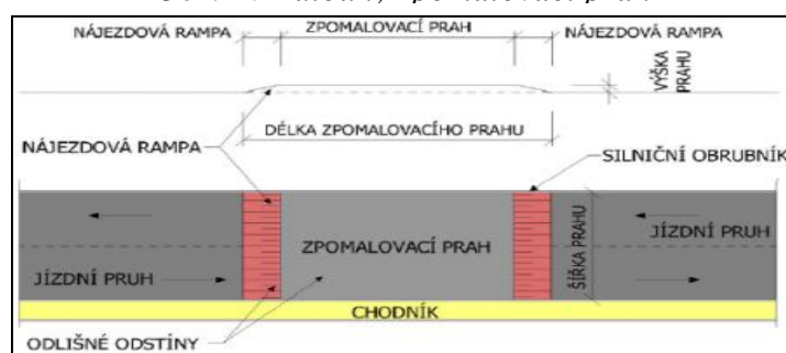
Obr. 20 - dlouhý zpomalovací práh
