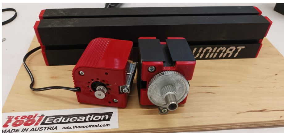
Obrázek 21: Motor (vlevo), spojka (uprostřed), hřídel (vpravo)
