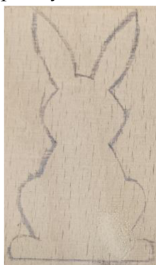
Obrázek 44: Překreslená šablona na borové překližce
