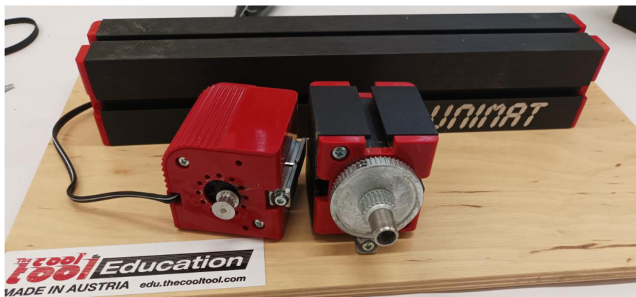
Obrázek 21: Motor (vlevo), spojka (uprostřed), hřídel (vpravo)
