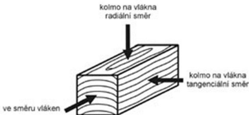
Obrázek 2 Směry zkoušení vlastností dřeva (ZSMV, 10.4.2018)
