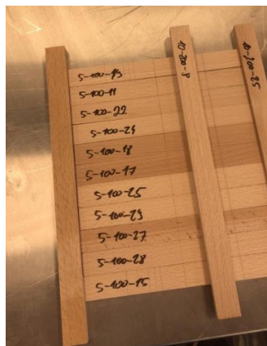
Obr. 17 Značení zkušebních těles (vlastní zdroj)
