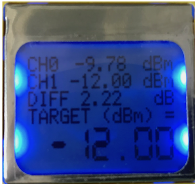
(a) Nastavený výstupní výkon -12,00 dBm (b) Varování nedostatečné úrovně signálu
