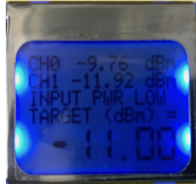
(a) Nastavený výstupní výkon -12,00 dBm (b) Varování nedostatečné úrovně signálu
