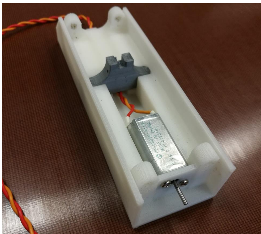
Obr. 32) uložení motoru a vedení kabeláže osy Z
