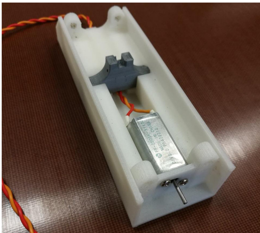
Obr. 32) uložení motoru a vedení kabeláže osy Z
