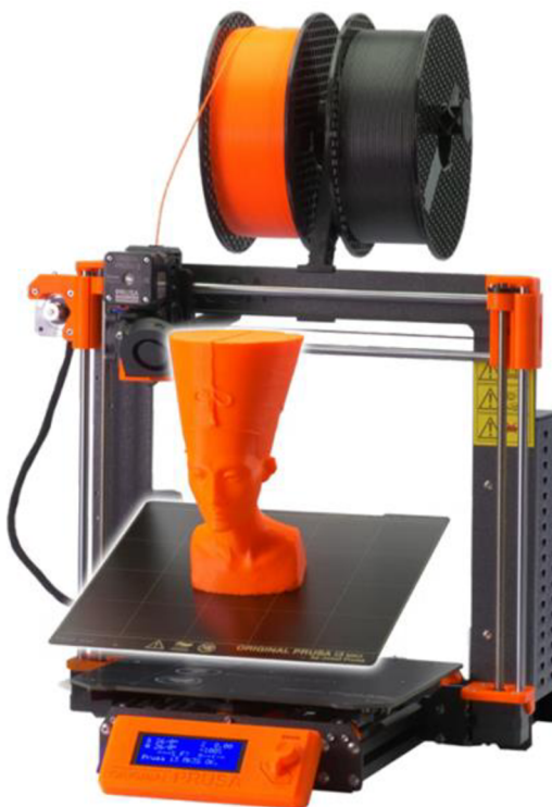
Obr. 4) 3D tiskárna českého výrobce Prusa i3 MK3S [8]
