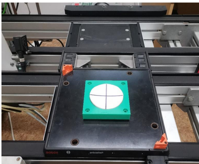
Obr. 14 Přemostění pásového dopravníku
