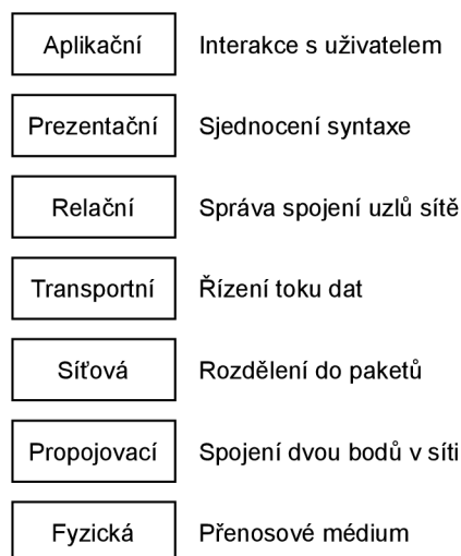
Obr. 2.1: Vrstvy protokolu Ethernet a jejich funkce
