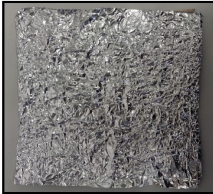
Obr. 37: Improvizovaný Lambertův zářič z hliníkové fólie.
