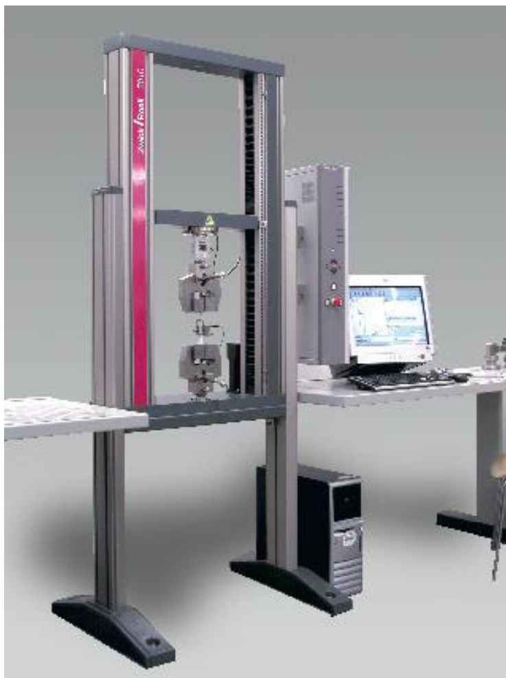
Obrázek 3.6: Univerzální testovací přístroj ZWICK [23]
