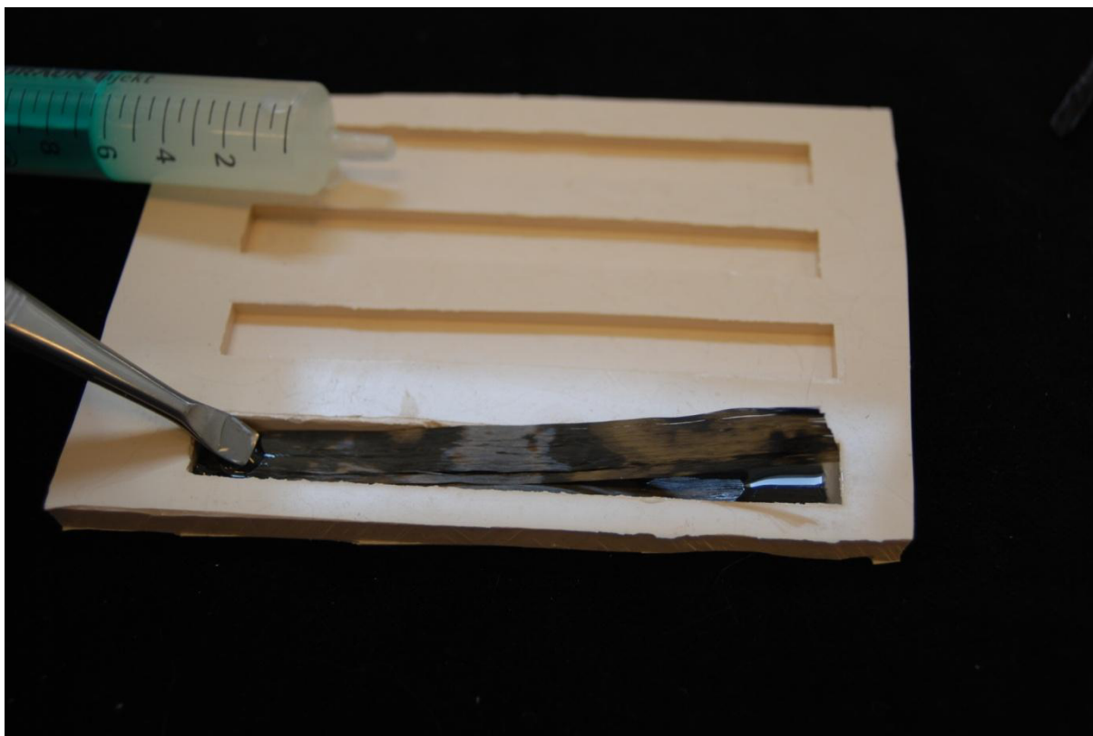
Obrázek. 3.5: Příprava zkušebního tělíška za pomoci nerezové pinzety
