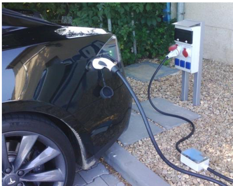
Obrázek 3-3 Středně rychlá dobíjecí stanice pomocí rozvaděče [5]
