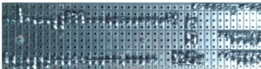
Obr. 3.3: Hlavní plošný spoj s připájenými vývody součástek
