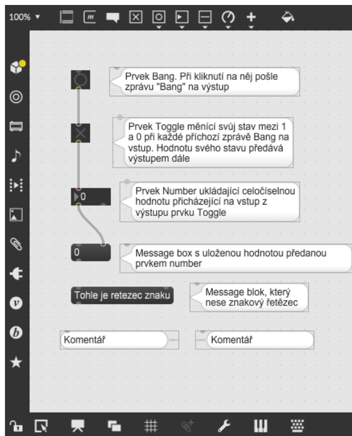
Obr. 1.11: Patch demonstrující použití základních prvků Max ®
