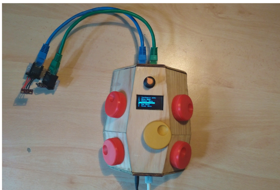
Obr. 3.11: Zapouzdřené funkční zařízení s připojenými senzory BMP280 a ADPS-9930
