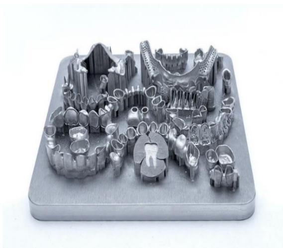
Obrázek 10 Chromkobalt laserem sintrovaný [30]
