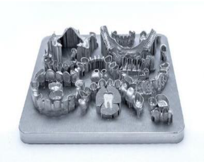
Obrázek 3 SLM-Selective Laser Melting [23]
