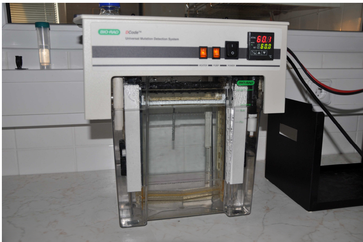
Obr. 7: DGGE, gel se vzorky na korpusu, který je ponořen temperované lázně (orig. ŠIMŮNEK, 2011)
