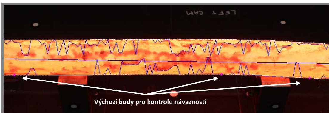
Obr. 5-13: Zobrazení výsledku 1. (modré hrany) a 2. (bílé hrany) fáze hlavní detekce včetně výchozího bodu pro kontrolu návaznosti (růžová hvězda). Je zřejmé, že z důvodu nastavené nízké prahové hodnoty bylo velké množství bodů v první fázi detekce nalezeno chybně uvnitř výkovku. Druhý krok zajistil správnou opravu všech chybných bodů..
