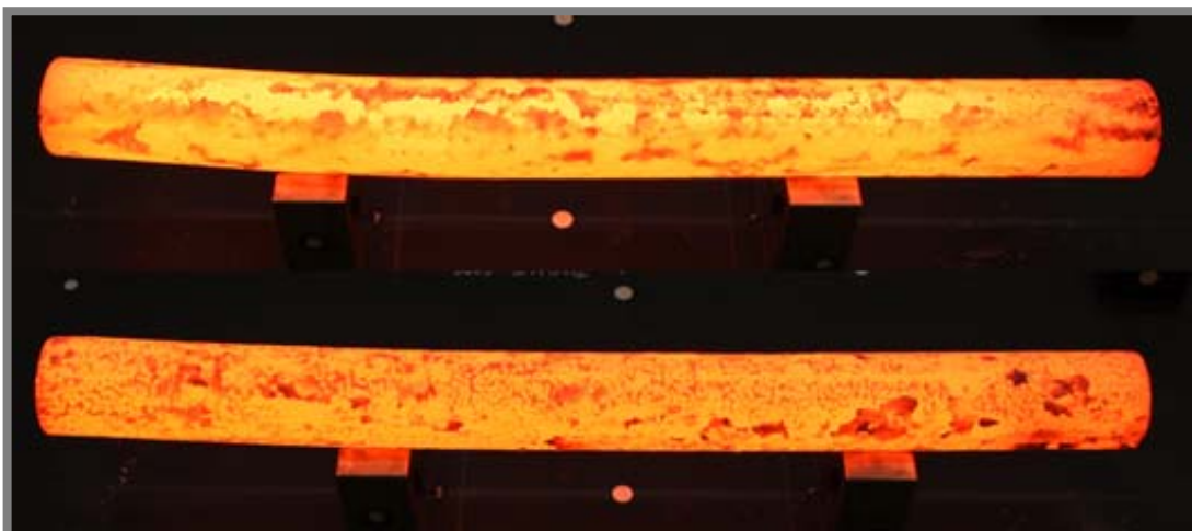
Obr. 6-6: Příklad snímků vzorku číslo 2 ohřátého na teplotu 1200 °C. Expoziční čas 1/40 s., ohnisková vzdálenost 18 mm, clona F7.1.
