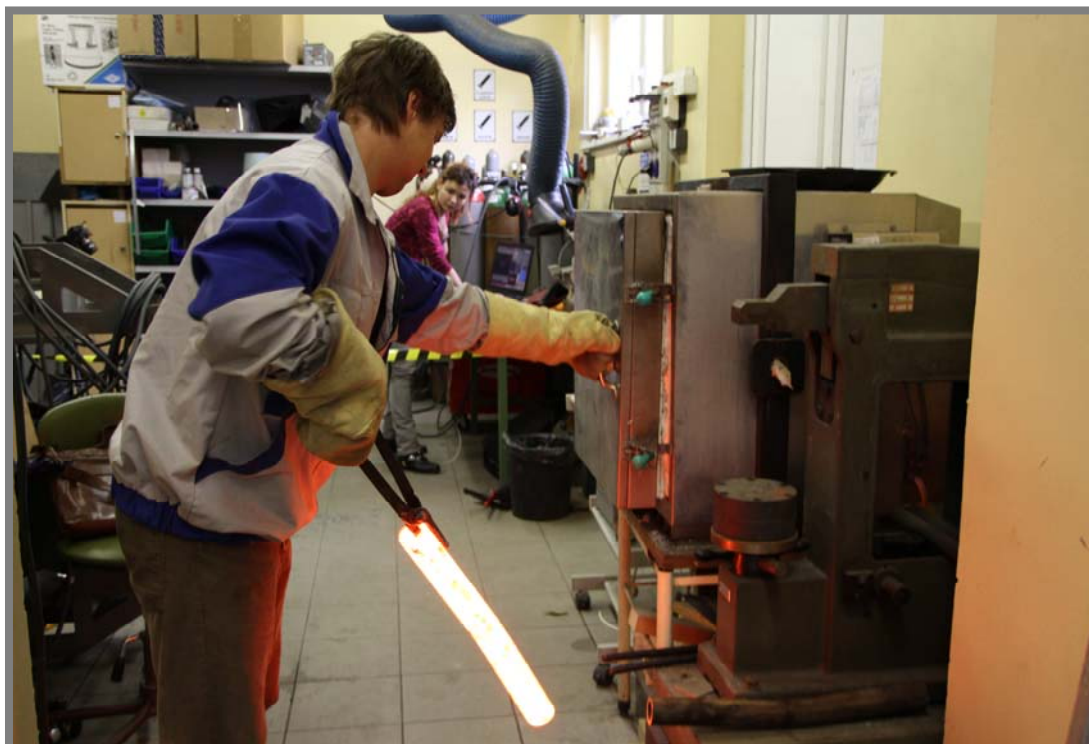
Obr. 5-37: Ohřev vzorků v indukční peci na 1200 °C.
