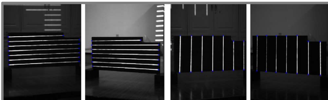
Obr. 2-22: Hraniční body detekované na ocelové desce v horizontálním a vertikálním směru [27].
