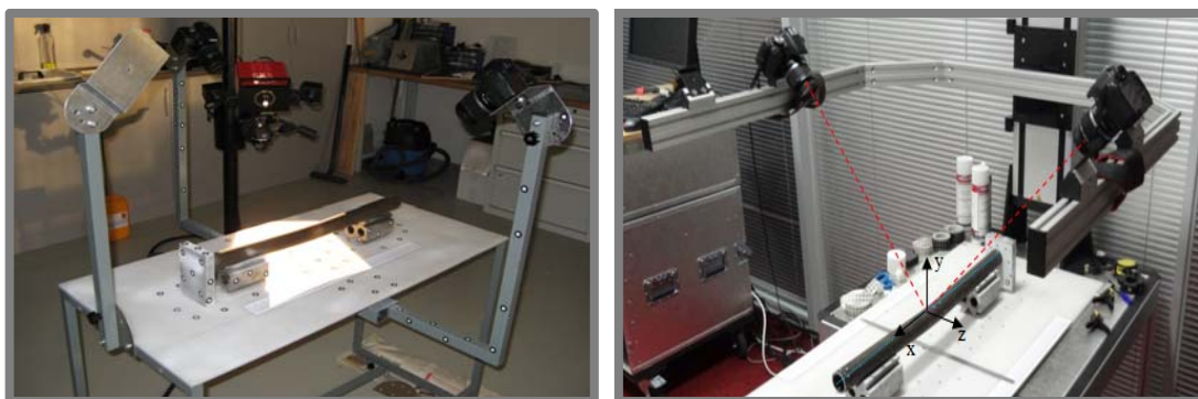
Obr. 5-35: Dvě realizované verze laboratorního stendu. Vlevo: stend s pevnými rameny. Vpravo: stend využívající lift, díky němuž je možný posun kamer ve vertikálním směru.
