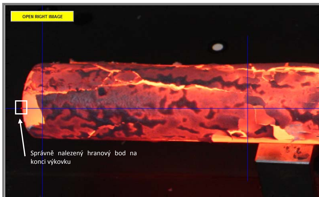
Obr. 5-9: Výsledek algoritmu iničiální detekce na zahřátém výkovku. I přes velmi výrazné okuje je při vhodném nastavení nalezena hledaná hrana (prahová hodnota 145, šířka mediánového okna 16 pixelů).
