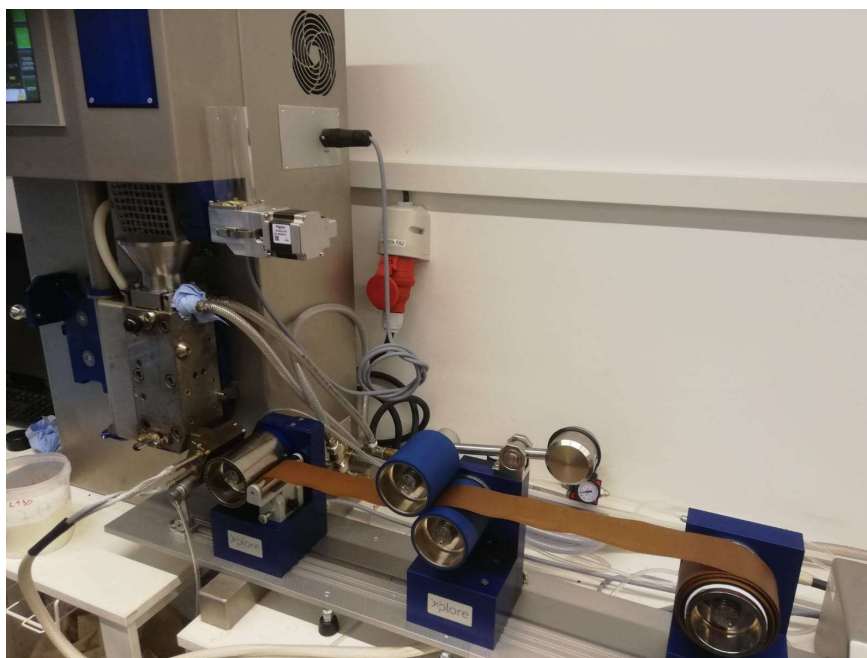
Obr. 3.12 Laboratorní vytlačovací linka pro výrobu kompozitních fólií
