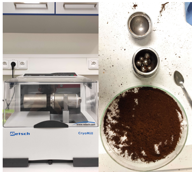
Obr. 3.3 Mlýn Retsch CryoMill
