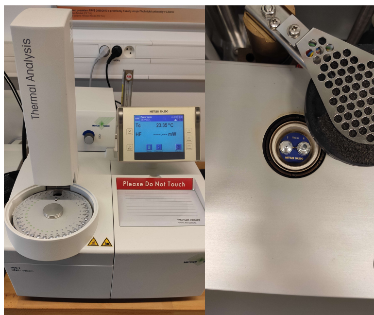
Obr. 3.18 Diferenční snímací kalorimetr Mettler Toledo DSC 1
