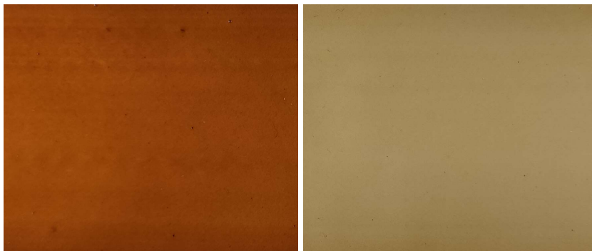
Obr. 3.34 Kompozitní fólie PLLA/ATBC/KS před (vlevo) a po (vpravo) atmosférickém stárnutí
