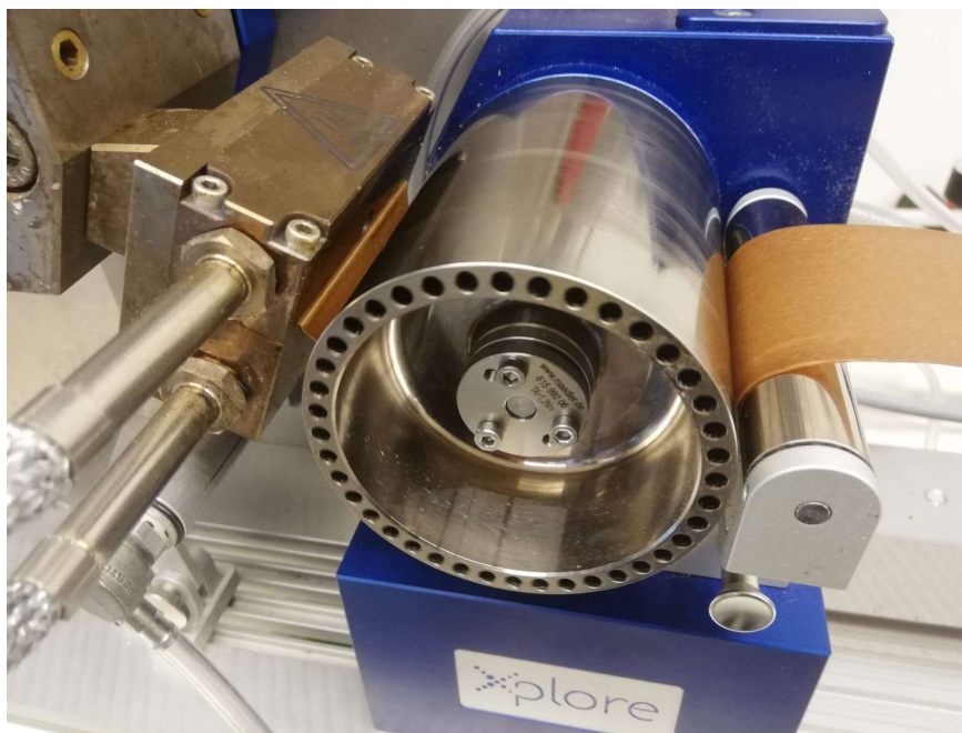
Obr. 3.11 Detail štěrbinové vytlačovací hlavy
