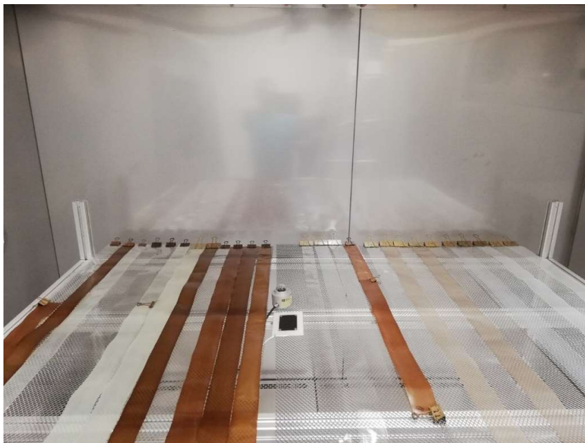
Obr. 3.31 Kompozitní fólie v klimatické zkušební komoře pro solární simulaci SUN 3600
