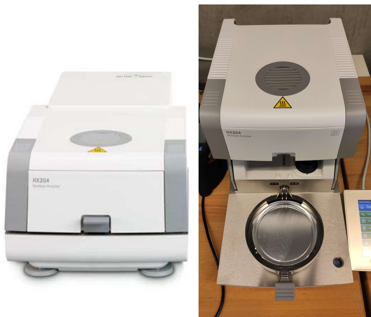
Obr. 3.40 Halogenový analyzátor Mettler Toledo HX204
