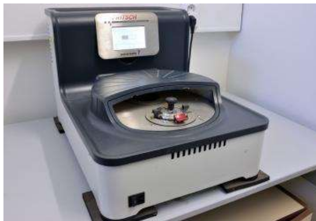
Obr. 3.4 Planetový mlýnu Pulverisette 7 premium line [81]
