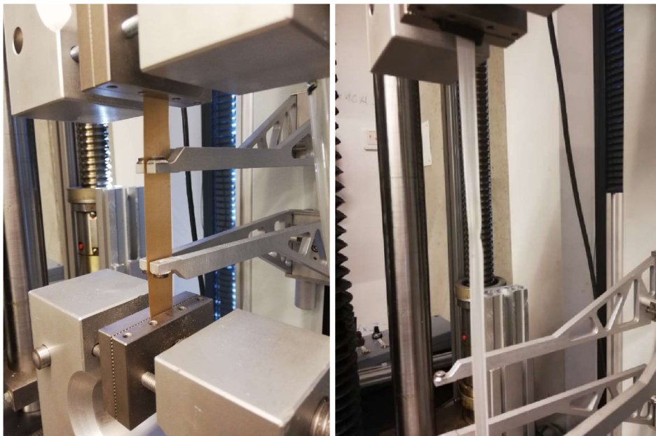
Obr. 3.42 Měření modulu pružnosti v tahu (vlevo) a jmenovitého poměrného prodloužení při přetržení (vpravo)
