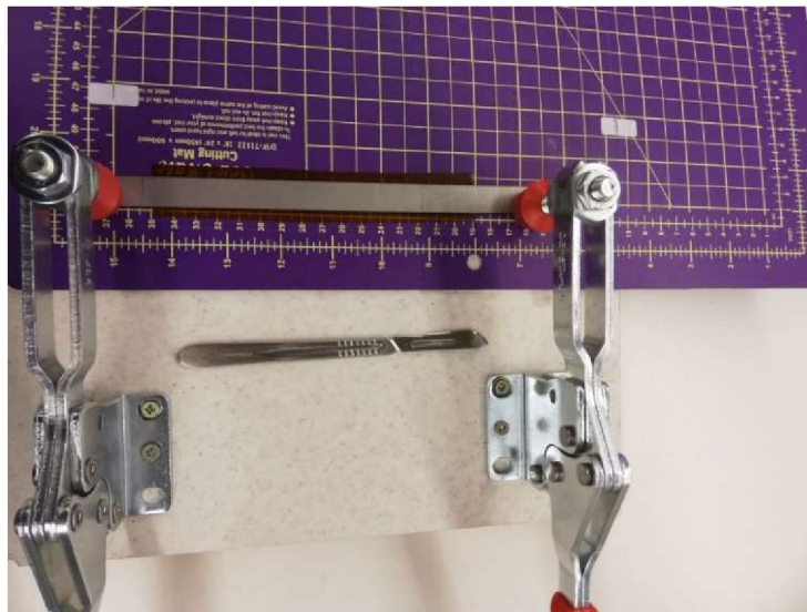
Obr. 3.41 Přípravek pro přípravu zkušebních těles typu 2 dle ČSN EN ISO 527-3 [94]
