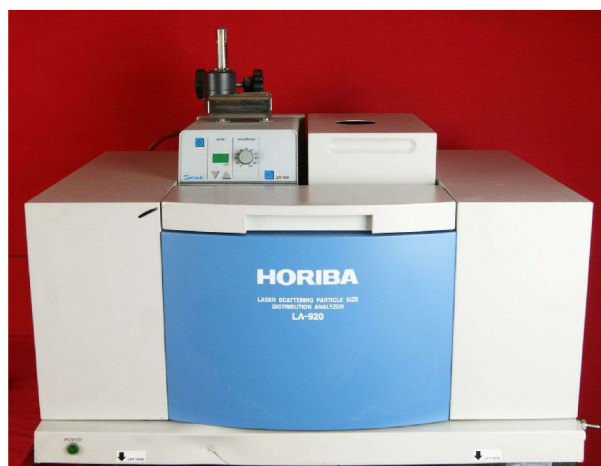
Obr. 3.6 Laserový difrakční analyzátor Horiba LA-920 [82]
