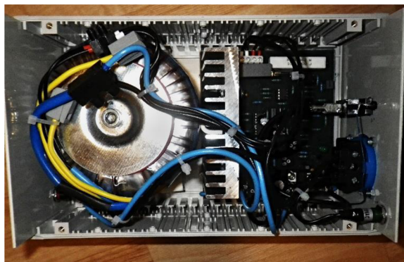
Obr. 3-1 Pohled shora na toroidní transformátor a střídač umístěný v plastové krabičce. Vodiče byly následně vyvedena bokem, aby nebránily proudění vzduchu chladičem.
