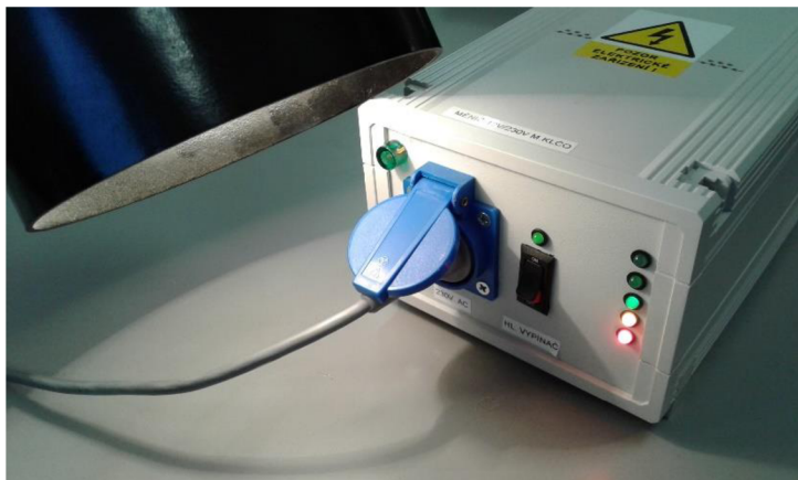
Obr. 3-11 Finální podoba střídače, zelená doutnavka vlevo nahore signalizuje živý výstup zásuvky 230 V AC
