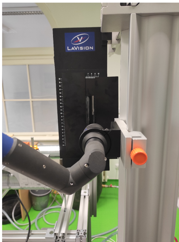
Obrázek 4.5: Světlovedné rameno s clonou nakonec ponechána konstantní, a to \tau = 330\ \mu\ s . Měření probíhala v rychlé sekvenci z důvodu úspory času, čemuž napomáhá jednotné nastavení.
