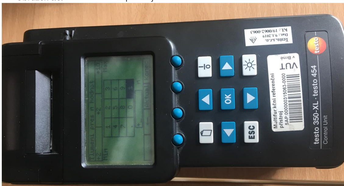
Obrázek č.9. Měřicí přístroj Testo 350-XL
