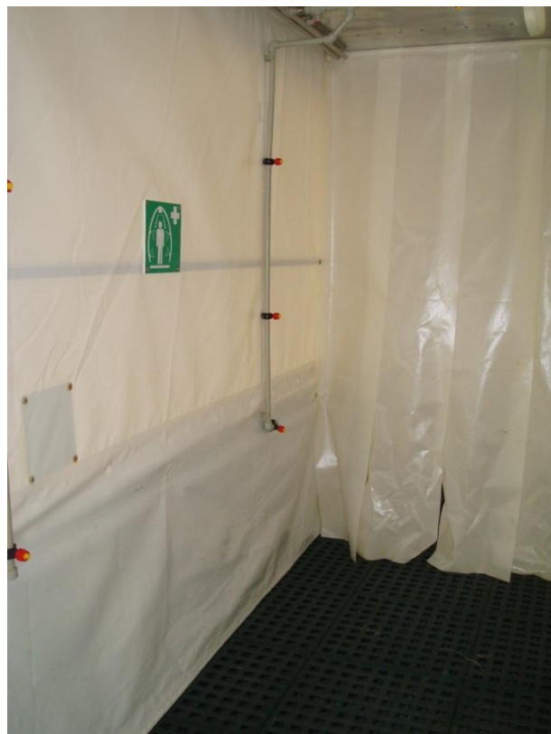
Obrázek č. 7 – dekontaminační sprcha ve střední části zařízení SDO II
