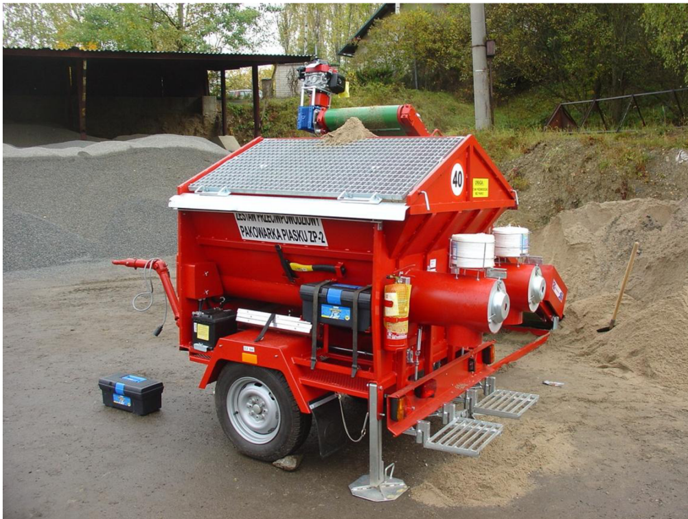
Obrázek č. 10 – mobilní pytlotačka písku ZP-2 (na jednokomorové pytle)
