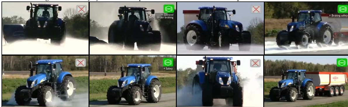
Obr. 50 Inteligentní brzdový systém ABS Super Steer na mokrém a suchém povrchu
