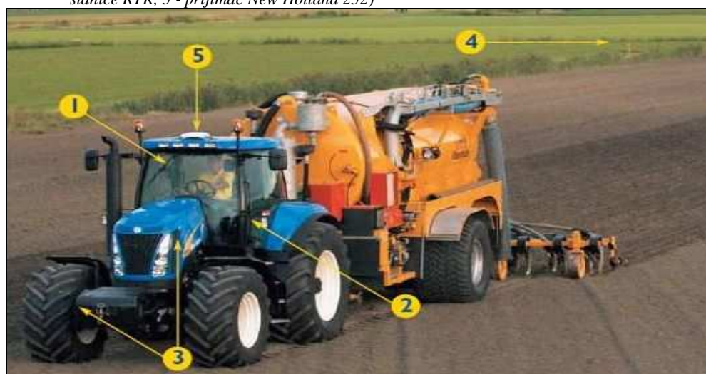
Obr. 61 Umístění jednotlivých členů systému automatického řízení Intelli Steer (1 - monitor Intelli View III, 2 - navigační ovladač, 3 - integrovaný řídicí systém, 4 - základní stanice RTK, 5 - přijímač New Holland 252)
