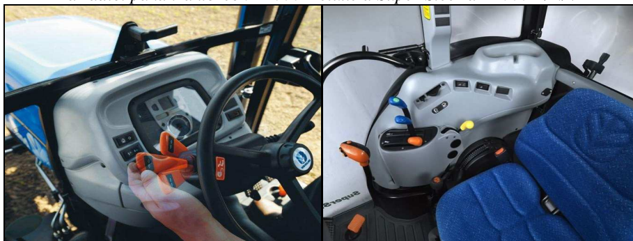
Obr. 33 Páčka elektrohydraulické reverzace Power Shuttle je klasicky pod volantem a řadící páka traktorech T4000 Deluxe a Super Steer a T4000 F/N/V
