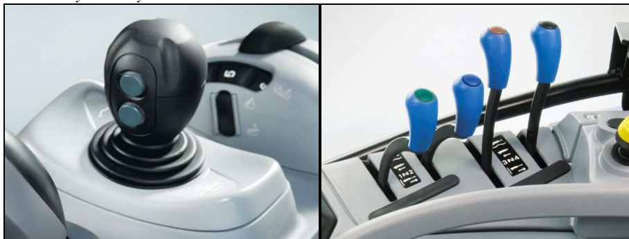
Obr. 38 Joystick pro ovládání vnitřního okruhu a páky pro ovládání vnějšího okruhu hydrauliky traktorů New Holland T7000 Power Command
