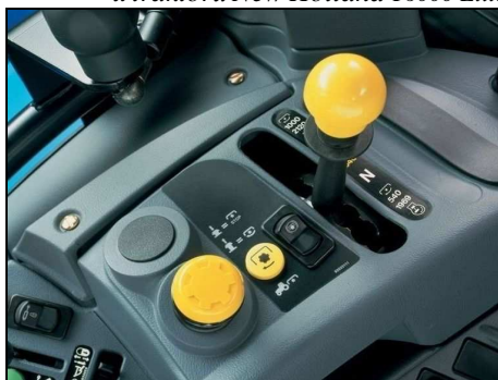
Obr. 40 Ovládání vývodového hřídele u traktorů New Holland T6000 Elite
