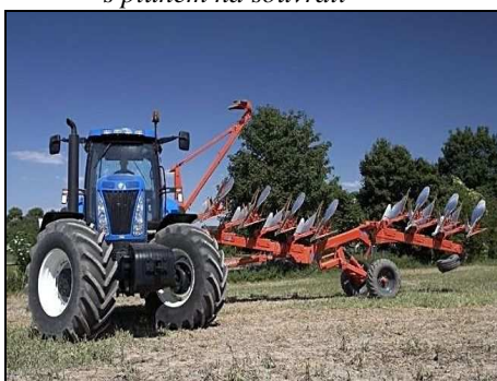
Obr. 41 Souvrat'ová automatika HTS v činnosti u modelu T8000 při otáčení s pluhem na souvrati
