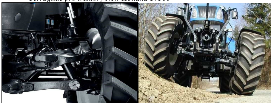
Obr. 45 Detail konstrukce nezávislého odpružení každého kola přední nápravy Terraglide pro traktory New Holland T7500
