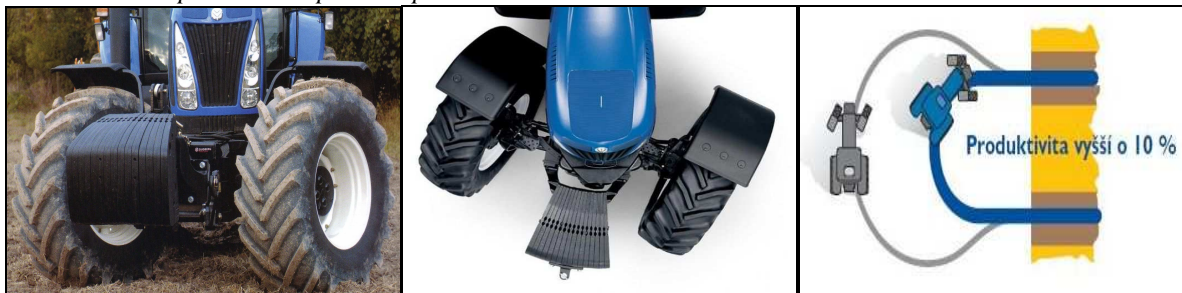
Obr. 46 Přední poháněná náprava Super Steer
