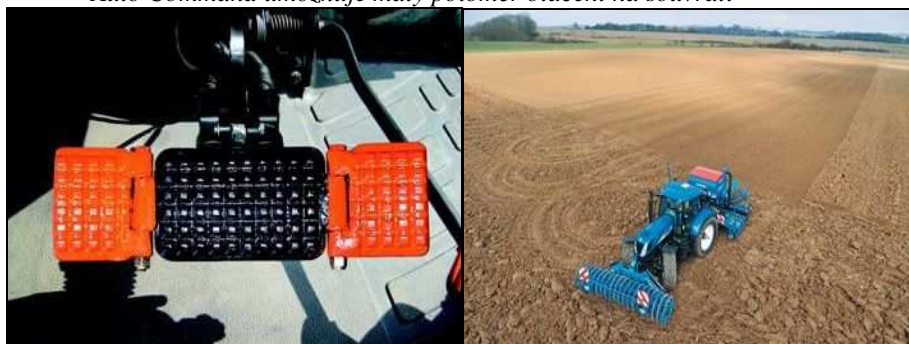
Obr. 48 Brzdový pedál se systémem ABS Super Steer traktoru New Holland T7000 Auto Command umožňuje malý poloměr otáčení na souvrati
