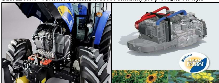
Obr. 12 Motor traktoru New Holland T5000 schválený pro provoz na bionaftu
