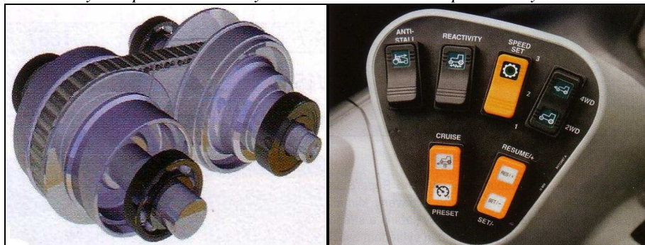
Obr. 36 Plynulá převodovka Easy Drive CVT s ovládáním převodovky
