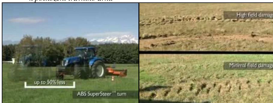
Obr. 49 Při otáčení na trvalém travním porostu s použitím ABS Super Steer nedochází k poškození travního drnu
