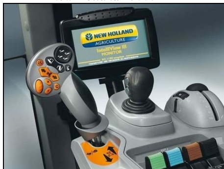
Obr. 23 Multifunkční ovládací páka převodovky Auto Command v traktoru New Holland T7000
