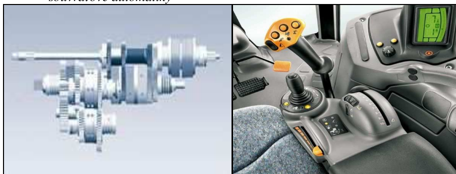
Obr. 24 Převodovka Power Command a ovládací páka traktoru sdružující tlačítka pro řazení převodových stupňů, přepínač rychlozdvihu TBZ a také tlačítko souvraťové automatiky
