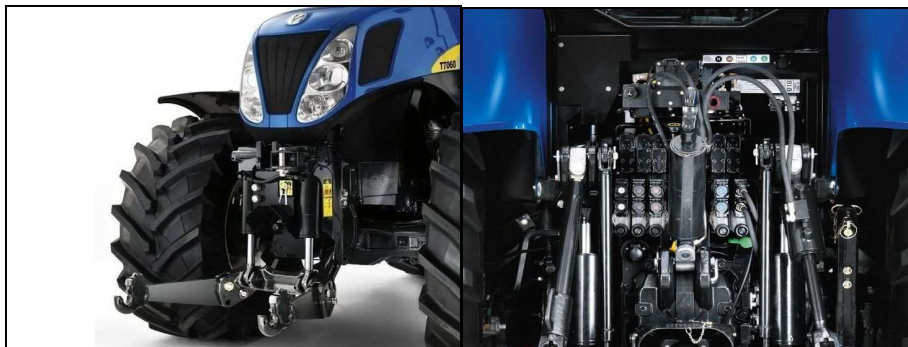
Obr. 37 Přední a zadní tříbodový závěs s vývody vnější hydrauliky traktorů New Holland T7000 Power Command
