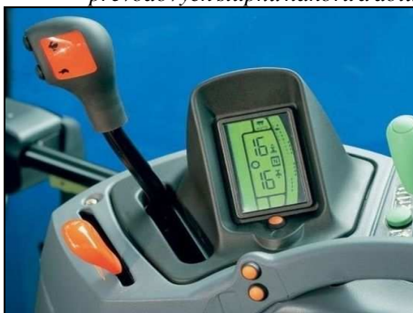
Obr. 26 Řadící páka převodovky Electro Command s tlačítky pro řazení převodových stupňů nahoru a dolů
