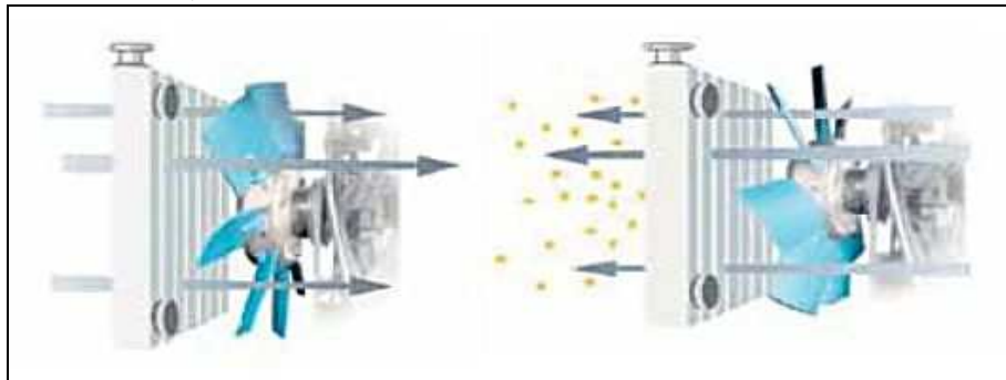
Obr. 20 Reverzní ventilátor Eco Fan
