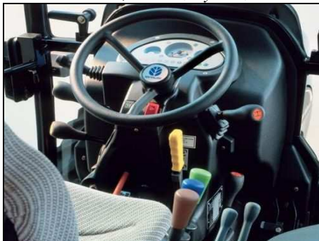
Obr. 35 Řadící páky převodovky Synchro Shuttle, s oranžovým označením
