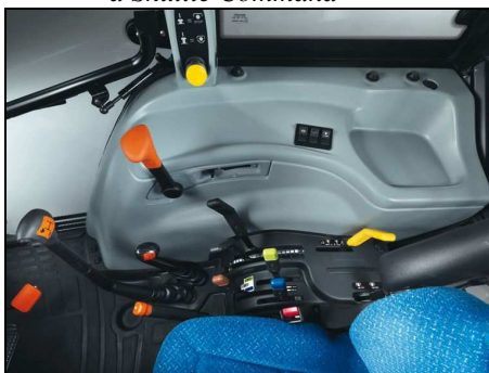
Obr. 30 Ovládací páka pro přebodovky Dual Command, Power Shuttle a Shuttle Command
