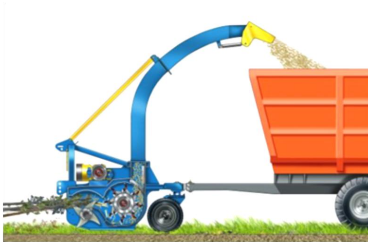
Obr. 15: Drtič s natáčecím výfukovým hrdlem
