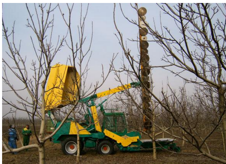
Obr. 9: Samojízdný drtič-štěpkovač se zásobníkem (www.speedy-cut.it, 2011)
