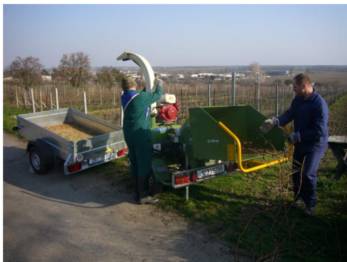
Obr. 7: Štěpkování odpadního réví pomocí mobilního štěpkovače (MAŠEK, 2005)
