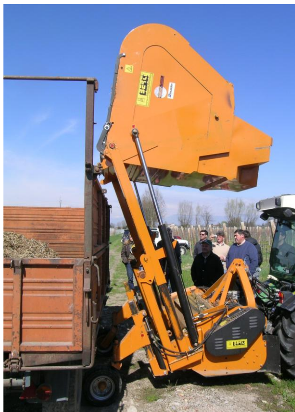
Obr. 24: Vyprazdňování naplněného zásobníku do přívěsu
