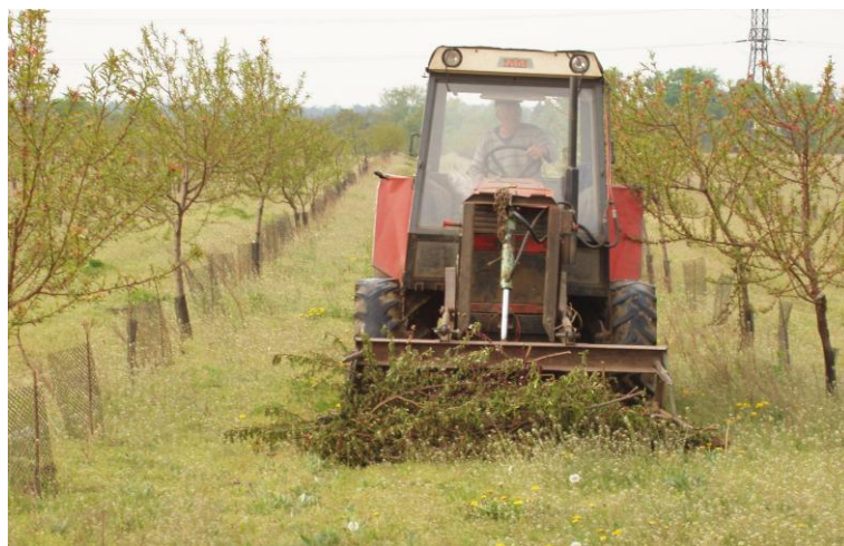
Obr. 5: Traktor s vidlemi – vyhrnování odpadního dřeva v ovocné výsadbě (BURG, 2007)
