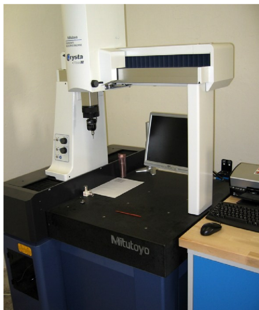
Obr. 5.1 Měřicí zařízení Mitutoyo 544 M Crysta [6]
