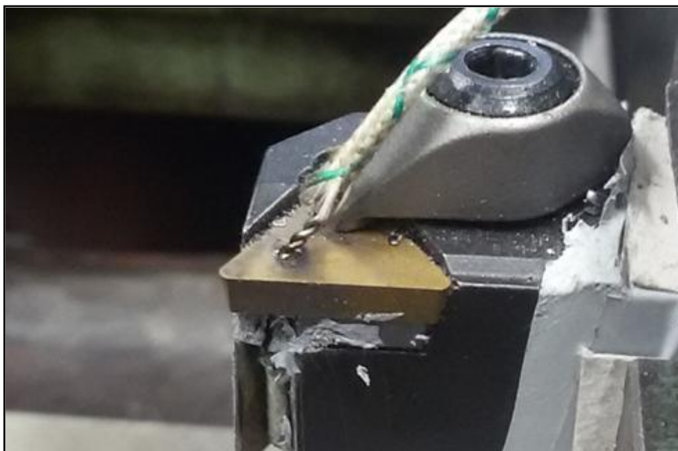
Obrázek 24 Stabilně zabudovaný termočlánek na vyměnitelné břitové destičce.
