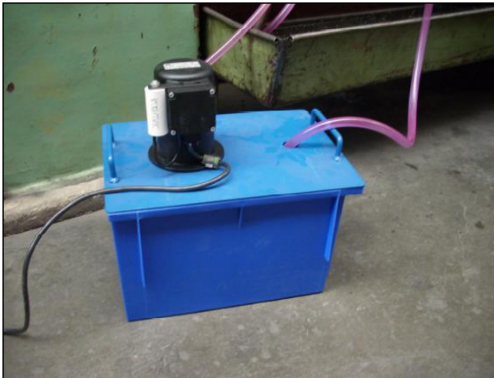
Obrázek 30 Čerpadlo a jímací nádoba na cirkulaci procesní kapaliny.
