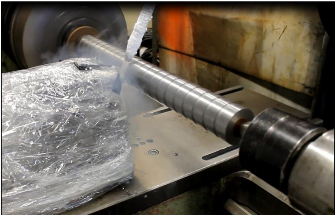
Obrázek 34 Obrábění pomocí tekutého dusíku.
