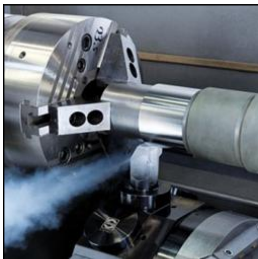
Obrázek 14 Chlazení břitu nástroje tekutým dusíkem – nepřímé chlazení [3].
