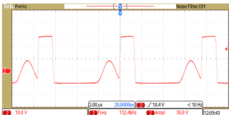
Obr. 43 Priebeh indukovaného napätia pomocného transformátora - odbočka -10V
