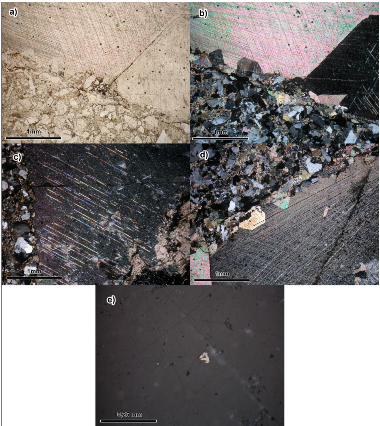
Obr. 36. Žíla 125/85 ve výbrusu. a,b) Málo zastoupená první generace karbonátu na okraji žíly. Krystaly jsou automorfně omezeny. Procházející světlo a) PPL, b) XPL. c) Neprůběžné dvojčatné lamely ve druhé generaci karbonátu. Procházející světlo XPL. d) Slabě deformované dvojčatné lamely v karbonátu. Pro srovnání byla přidána černá linka. Procházející světlo XPL. e) Zrno pyritu v karbonátu druhé generace. Odražené světlo PPL.
