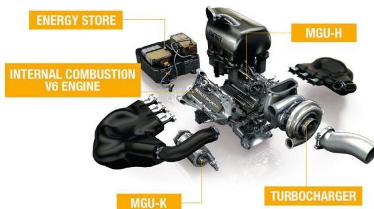
Obr. 17 Pohonná jednotka pro vozy Formule 1 Renault Energy F1-2014 [10]
