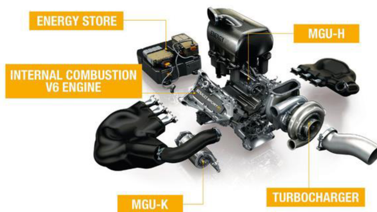
Obr. 17 Pohonná jednotka pro vozy Formule 1 Renault Energy F1-2014 [10]
