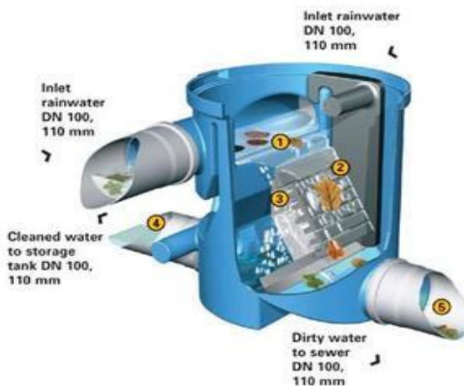
Obr. 5: Filtr instalovaný do nádrže (Zdroj: Freeflush).
