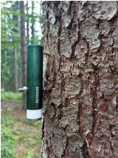
Obrázek 2: Dendrometr TOMST instalovaný na smrku ztepilém s evidenčním číslem (92192530). Přístroj je ke stromu připevněn zavrtaným šroubem.
